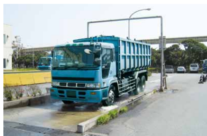
車両用消毒槽
