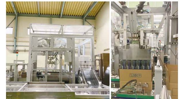
産業用ロボットによるボトル整列・ケーシング
