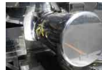
ローリー車の封印 （ホース取り付け口、外カバー）
