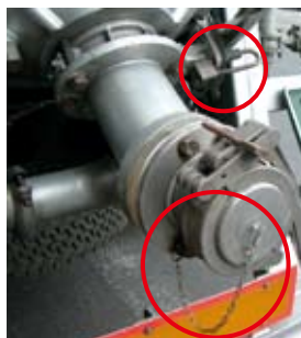
ローリー車の封印
